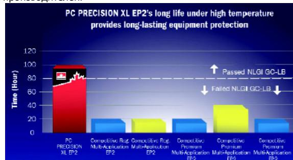
Сравнение результатов испытания ресурса подшипника по стандарту ASTM D3527 при 160°C, скорости 1000 об/м и осевом давлении 111 Н
