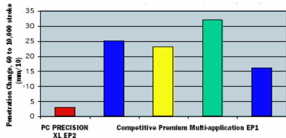
**Повышенная стабильность на сдвиг при малых скоростях смазки PRECISION XL EP1 увеличивает интервал замены.**
