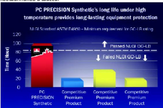
Сравнение результатов испытания ресурса подшипника по стандарту ASTM D3527 при 160°C, скорости 1000 об/м и осевом давлении 111 Н для смазок PRECISION Synthetic и универсальных высококачественных смазок других лидирующих производителей.
