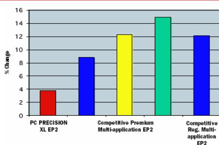
**Повышенная стабильность на сдвиг при средних скоростях смазки PRECISION XL EP1 увеличивает интервал замены.**
